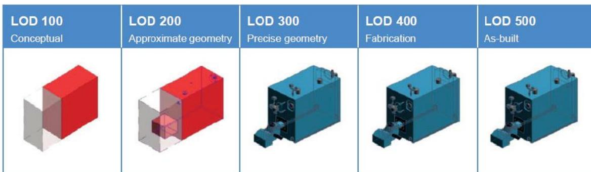
Abbildung 1: Beispiel für verschiedene Fertigstellungsgrade [20]
